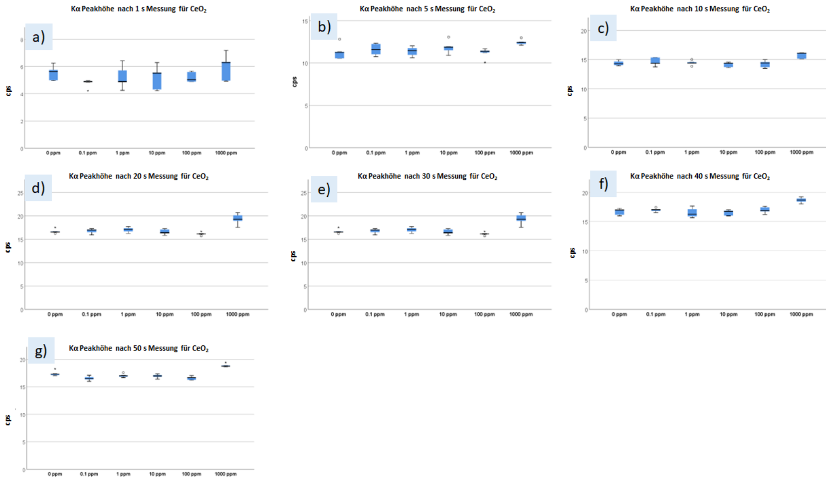
Abbildung 7: Boxplot-Darstellung der maximalen K \alpha -Peakhöhe für Cerium in verschiedenen Messzeitintervallen: Messzeitintervallen: 1s (a), 5s (b), 10s (c), 20s (d), 30s (e), 40s (f), 50s (g).
