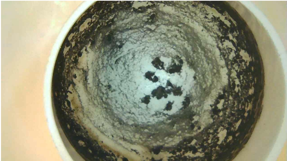
Abbildung 11: \text{Al}_2\text{O}_3 -Tiegel für TGA mit Asche aus verbranntem POM H-500 mit \text{Y}_2\text{O}_3 -Markermaterial, welches aufgrund des hohen Schmelzpunktes in der Asche verbleibt.
