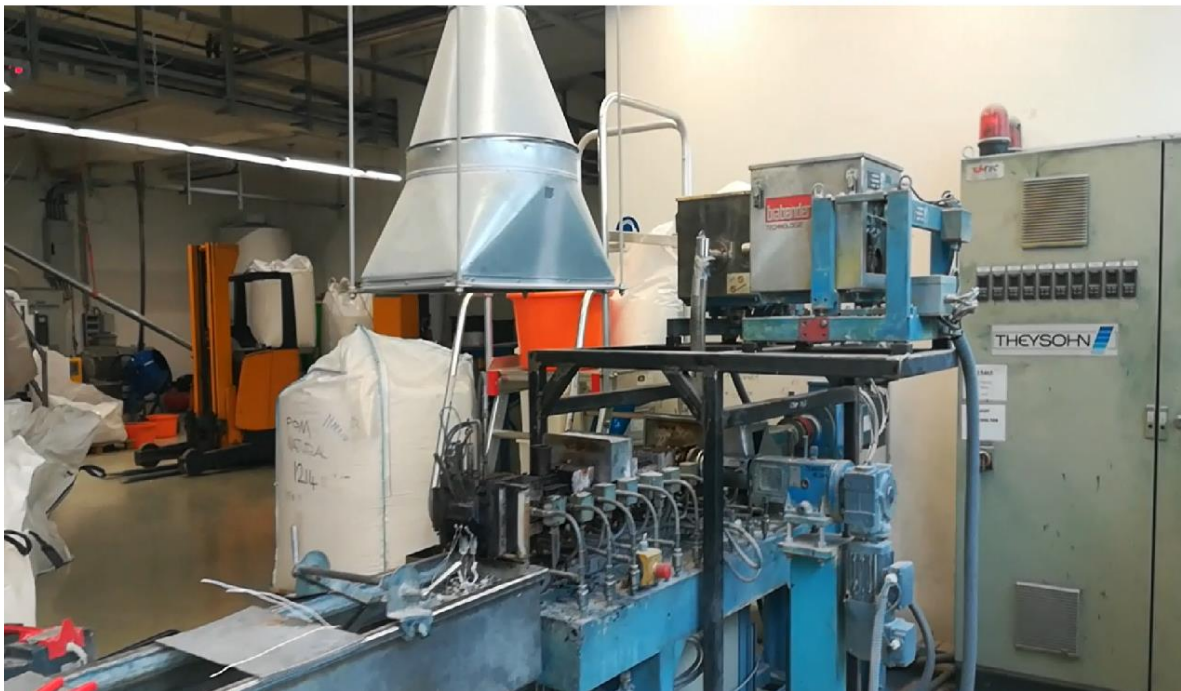
Abbildung 3: Bild oben: Schematischer Ablauf der Extrusion bzw. Herstellung der POM-Pellets, die für die Prüfkörperpressung verwendet wurden. Bild unten: Doppelschneckenextruder des Projektpartners Polymerwerkstatt GmbH am Standort Krems.
