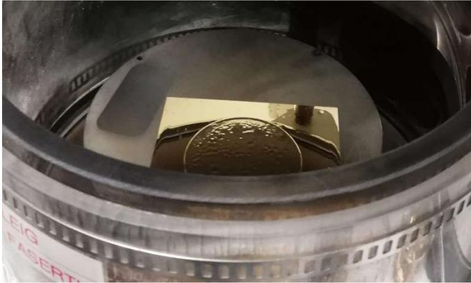
Abbildung 15 Gold besputterte PET Membran immobilisiert auf einem Objektträger in der Sputterdepositionsanlage
